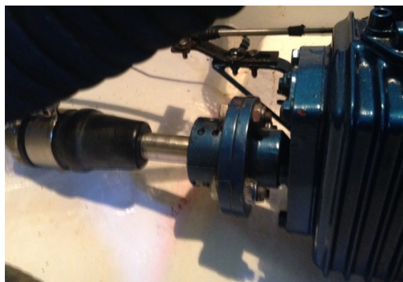
Fig. 2. Eje y reductora de la hélice de un barco de pequeña eslora.
